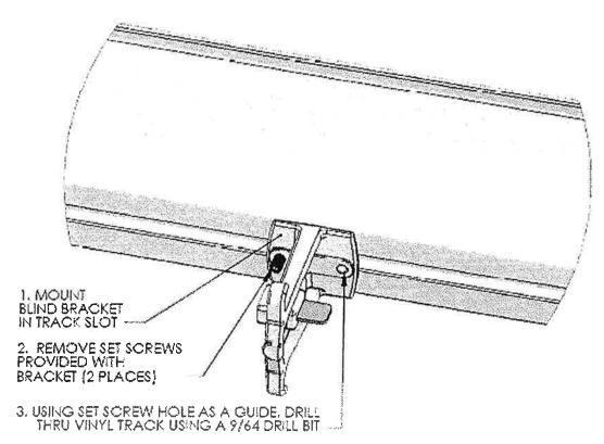
4. INSTALL BLIND BRACKET USING SCREWS PROVIDED (SHADETREE P/N F022)
